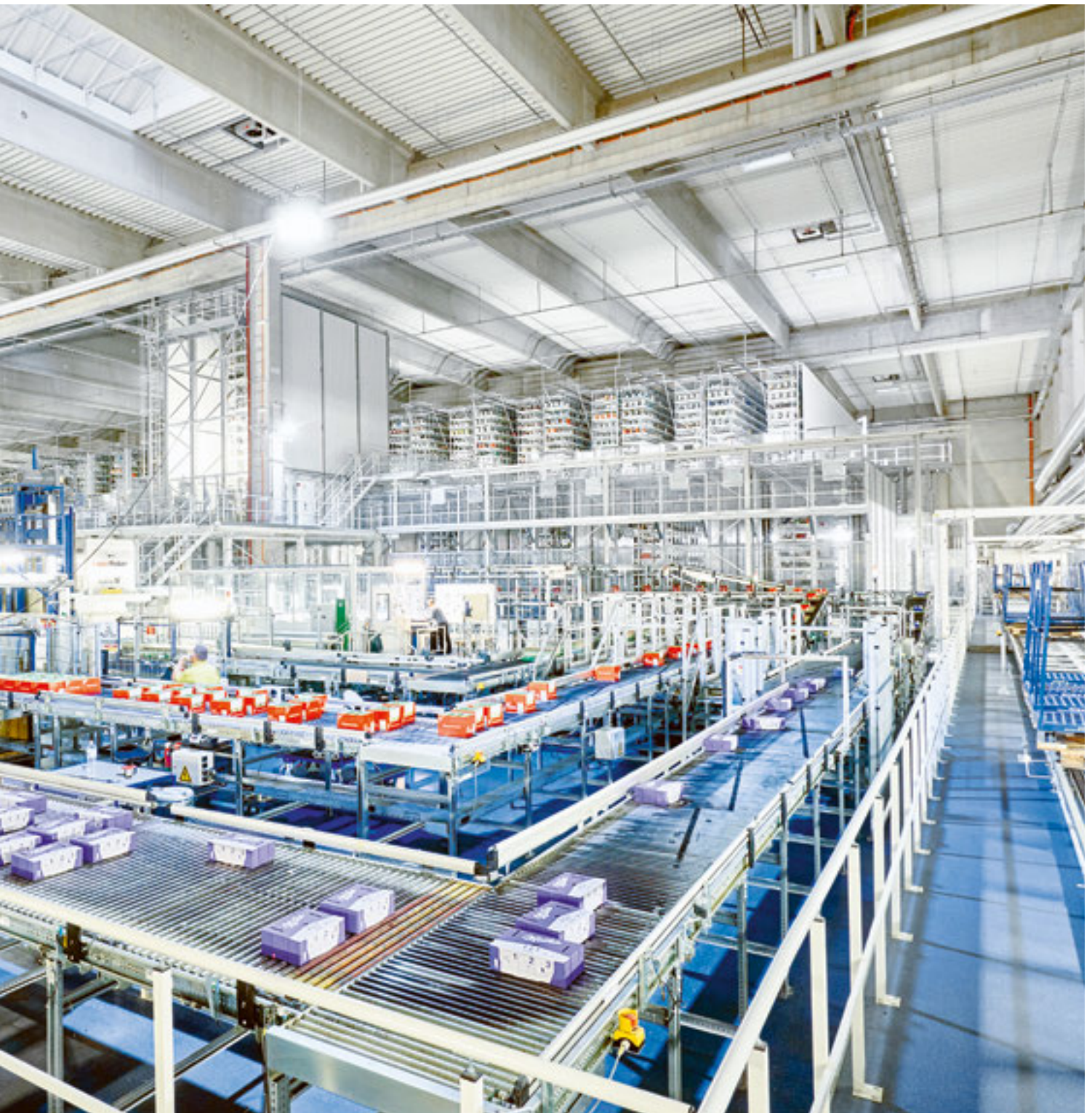
Modernste Entwicklungen und innovative Technik kommen in der Logistik bei EDEKA Nord zum Einsatz. Hier lagert das vollautomatische OPM-Lager (Order Picking Machinery) in Zarrentin Ware ein.
